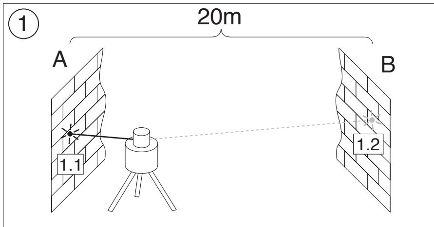
Sijoita nyt laite seinän B lähelle. Kohdista lasersäde tasatusta laitteesta X-akselin suuntaan lähellä olevaan seinään B siten, että aikaisemmin merkitty korkeus (mittauksesta seinältä A) on samalla kohdalla. Käännä laitetta 180°, tasaa se ja merkitse säteen keskikohta seinään A. Molempien tässä merkityjen kohtien välinen ero (h) ilmoittaa tosiasiallisen laitepoikkeaman.
