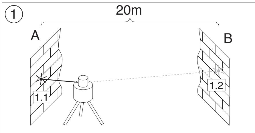
Plaats het apparaat nu dicht bij muur B. Richt de laserstraal van het waterpas gestelde apparaat in de X-asrichting van muur B, zodat de eerder gemaakte hoogte (vanuit de meting van muur A) exact gerealiseerd is. Draai het apparaat 180°, het waterpas laten stellen en het midden van de straal op muur A markeren. Het verschil (h) tussen hier gemaakte punten levert nu de werkelijke apparaatafwijking op.
