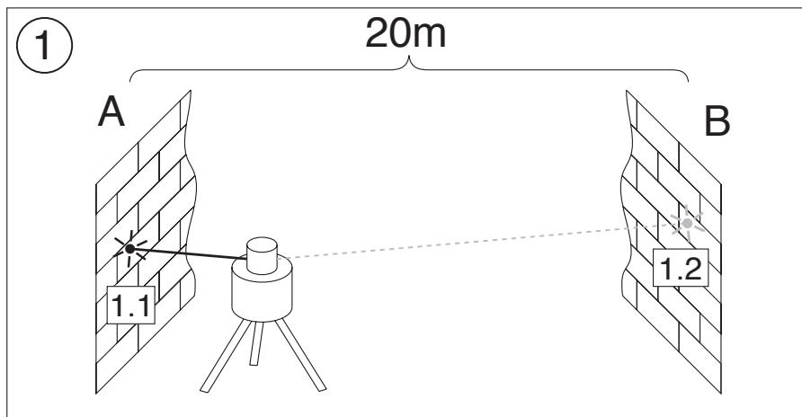
Entonces, coloque el aparato cerca de la pared B. Dirija el rayo láser del aparato nivelado en el sentido del eje X hacia la pared que ahora más cercana B, de modo que la altura marcada antes (de la medición de la pared A) se realice. Gire el aparato en 180°, nivéelo y marque el centro del rayo en la pared A. La diferencia (h) de ambos puntos marcados da el resultado de la desviación real del aparato.
