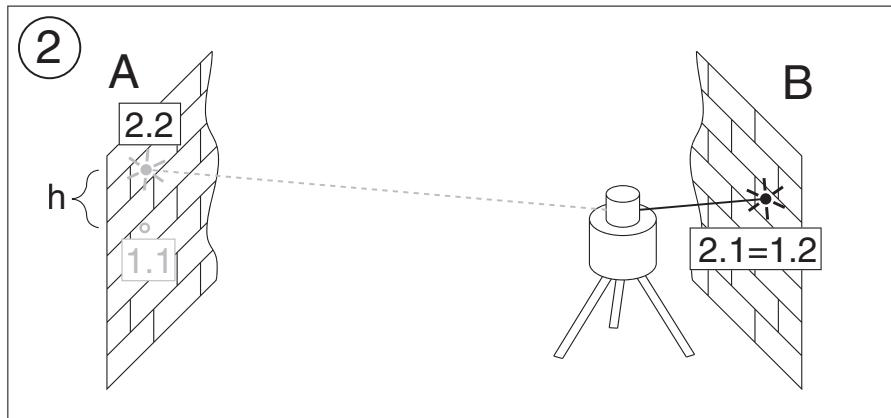
Eğer alet endüstriyel hassasiyetin ( $10\text{ m de } \pm 1,0\text{ mm}$ ) sınırında bulunuyorsa, o zaman sıfır durumuna olan,  $20 + 20 = 40\text{ m}$  de en fazla tolerans 4 mm dir.
