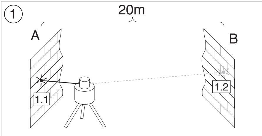
raggio sul muro distante A. La differenza (h) dei due punti contrassegnati da l'esatto errore dello strumento.
