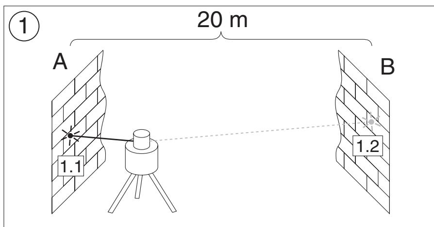
今度はB壁の近くに、X軸のプラス側がB壁を指すように本体を設定します。本体が水平になつたら、B壁のレーザ光の高さをマークします。本体を180度回転して、本体に自動整準させ、A壁のレーザ光の中心をマークします。A壁のマークの差が偏差を意味します。
