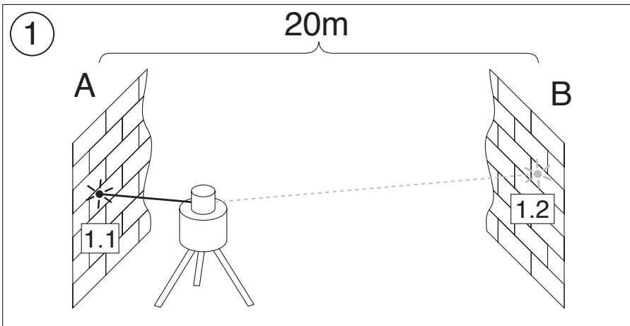
A seguir, posicione o aparelho nas proximidades da parede B. Dirija o feixe de laser do aparelho de nivelação na direcção do eixo X para a parede próxima B, de maneira que a altura marcada anteriormente (a partir da medição da parede A) seja realizada. Gire o aparelho de 180°, deixe-o nivelar e marque o centro do feixe na parede A. A diferença ( $h$ ) de ambos os pontos aqui marcados resulta, então, no desvio real do aparelho.
