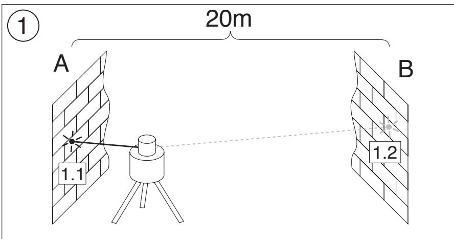
Placera nu apparaten nära vägg B. Rikta den avvägda apparatens laserstråle i X-axel-riktning mot väggen B som nu är nära, så att exakt den höjd som markerats innan (vid mätningen utifrån vägg A) realiseras. Vrid apparaten 180°, låt den avvägas och markera strålens mitt på vägg A. Differensen ( $h$ ) av de båda markerade punkterna här utgör apparatens faktiska avvikelse.
