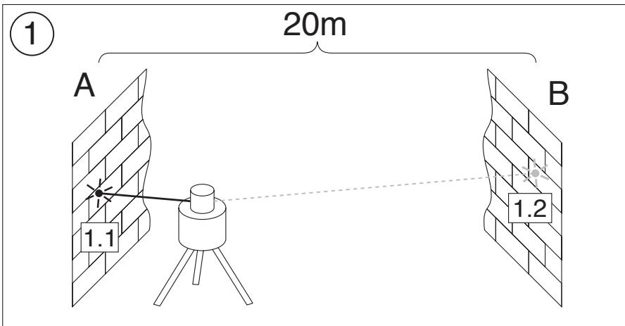
Nå plasserer du apparatet i nærheten av vegg (B). Du retter laserstrålen til det nivellerte apparatet i retning av X-aksen til vegg B som er nærmest, slik at den nøyaktig høyden som er blitt markert på forhånd (fra målingen til vegg A) er realisert. Du dreier nå apparatet 180°, lar det bli nivellert og du markerer midten på strålen på vegg A. Differansen (h) til de to markerte punktene gir nå den virkelige avvikelsen til apparatet.
