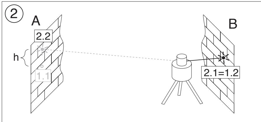
Si el aparato está en el límite de la precisión de fábrica ( $\pm 1,0 \text{ mm a } 10 \text{ m}$ ), en  $20 + 20 = 40 \text{ m}$ , la divergencia máxima de la posición cero será de 4 mm.
