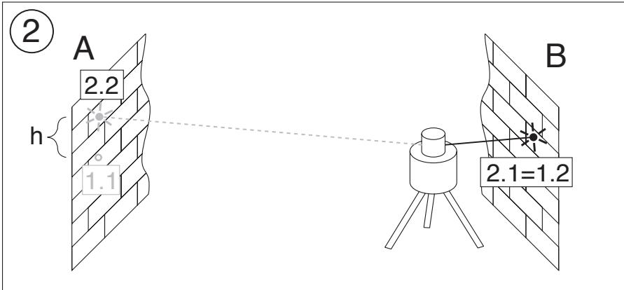
Om apparaten ligger vid fabriksnoggrannhetens gräns ( $\pm 1,0 \text{ mm}$  på  $10 \text{ m}$ ) så är den maximala avvikelsen från nolläget  $4 \text{ mm}$  vid  $20 + 20 = 40 \text{ m}$ .
