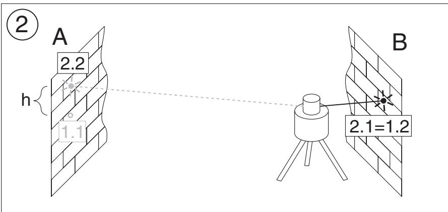
本体が作業精度の許容範囲内にあるためには、 $20\text{ m} + 20\text{ m} = 40\text{ m}$ の実レベルでの最大偏差は4mm未満の必要があります。
