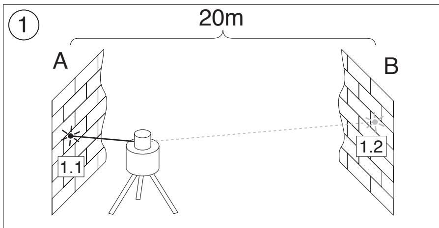
Nun den Laser nahe der Wand B platzieren. Ausrichten des nivellierten Lasers in der + X-Achsen-Richtung zur nun nahen Wand B, so dass genau die zuvor markierte Höhe (aus der Messung von Wand A aus) realisiert ist. Drehen des Lasers um 180°, nach der Nivellierung, Höhe an der Wand A markieren. Die Differenz (h) der beiden hier markierten Höhen ergibt nun die tatsächliche Laserabweichung.
