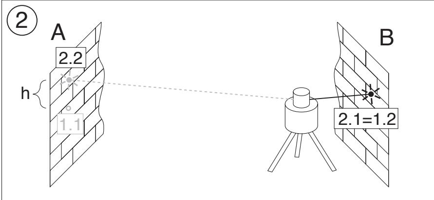
Se o aparelho se encontrar no limite da exactidão de fábrica ( $\pm 1,0\text{ mm em }10\text{ m}$ ), o desvio máximo em relação à posição zero, em  $20 + 20 = 40\text{ m}$ , é de 4 mm.
