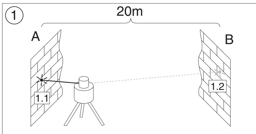
Şimdi aleti B duvari yakınında yerleştiriniz. Tesviye edilmiş aletin lazer işinini X-ekseni-istikametinde şimdi yakın olan duvar B ye, daha önce işaretlenmiş yükseklik (duvar A ölçümünden olan) gerçekleştirilebilecek şekilde doğrultunuz. Aleti 180° çeviriniz, tesviye etmeye bırakınız ve duvar A daki işin ortasını işaretleyiniz. Burada işaretlenmiş her iki noktanın farkları (h) şimdi gerçek alet toleransını belirlemektedir.
