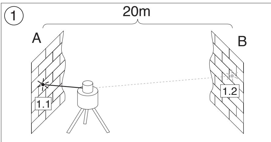
Nu placeres apparatet i nærheden af væg B. Det nivellerede apparats laserstråle rettes i X-aksens retning mod den nærmeste væg B, således at den forinden markerede højde (fra målingen på væg A) rammes nøjagtigt. Apparatet drejes 180°, nivelleres og strålemidt markeres på væggen A. Differencen ( $h$ ) mellem de to markerede punkter udgør den faktiske apparatafgivelse.
