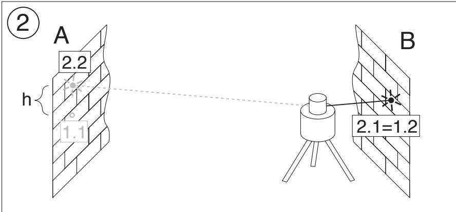
Jos laite on tehdasasetuksen rajoilla ( $\pm 1,0 \text{ mm}$  10 m:ä kohden), on  $20 + 20 = 40 \text{ m:ssä}$  maksimipoikkeama nolla-asennosta 4 mm.
